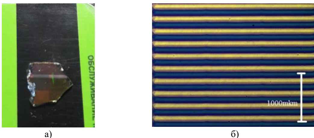
Рисунок 5 – Иллюстрация: а – фотография магнитоплазмонного образца, расположенного на пластиковой карте с намагниченным слоем, б – магнитооптическое изображение магнитной информации в магнитной слое, полученное с помощью визуализатора «Маг-Видео»
