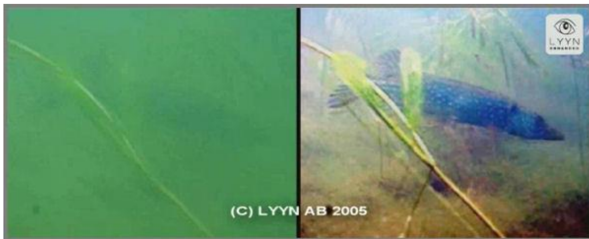
Рисунок 16 – Эффективность работы устройства видеокоррекции LYYN T38 в ухудшенных условиях видения в замутненной воде: вид слева – без коррекции, вид справа – с коррекцией
