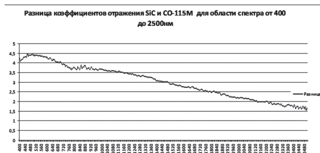
Рисунок 9. Относительное изменение коэффициента отражения
