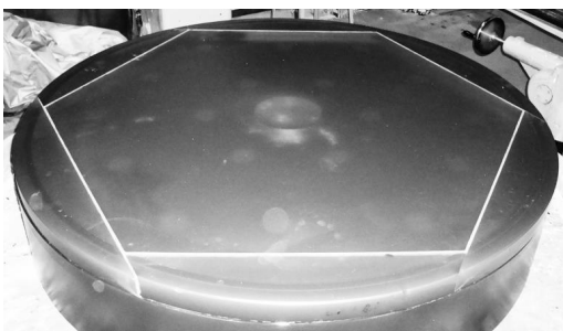
Рисунок 9. Изготовление сегмента методом асферизации малым инструментом
