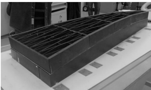
Рисунок 21. Панель из углепластика на матрице
