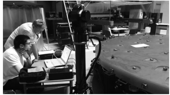
Рисунок 6. Аттестация высот интерфейсных элементов
