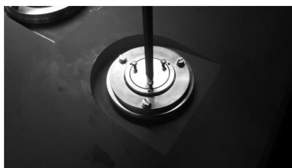
Рисунок 2. Юстировка прототипа интерфейсного элемента на координатном станке
