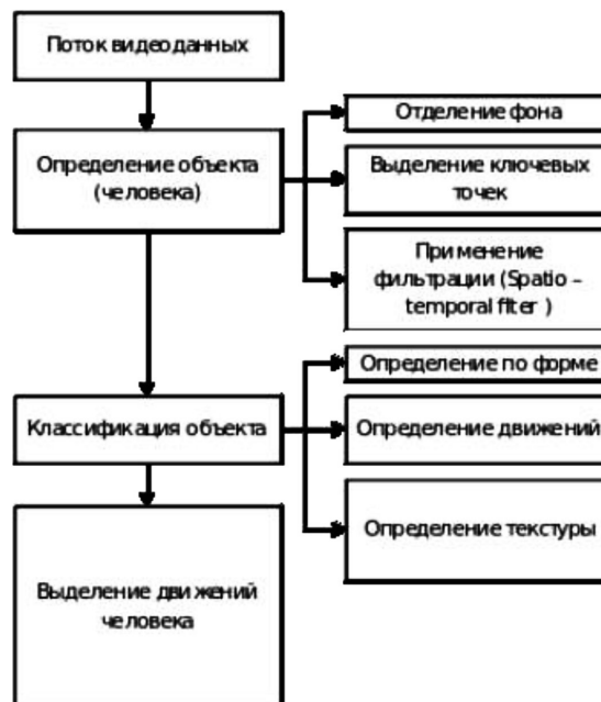
Рисунок 6. Структурная схема решения задачи определения человека в случае построения текстурно – глубинного трехмерного представления
