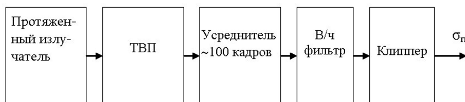
Рисунок 2. Схема измерения СКО пространственного шума \sigma_{\text{н}}
