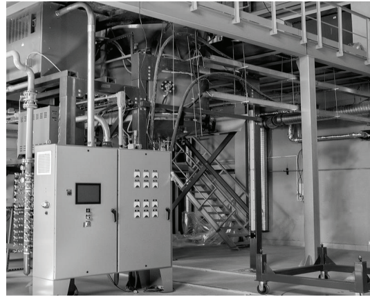
Рисунок 2. Установка синтеза высокочистого поликристаллического селенида цинка лазерного качества CVD-методом
