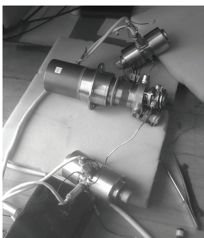
Рисунок 6. Опытный образец ФПУ, состыкованный с двумя ГKM 2-го класса (МСМГ-3В-1/80)
