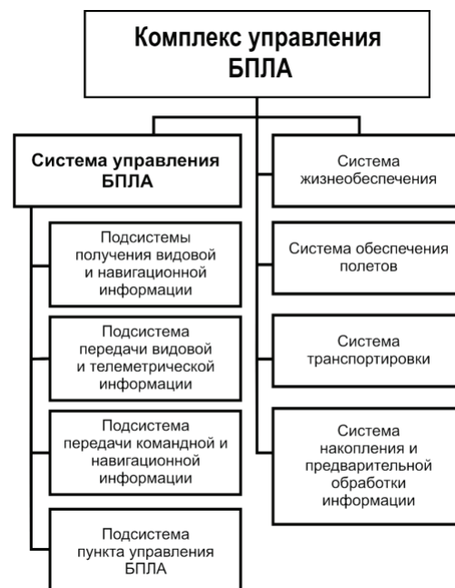
Рисунок 2. Устройства, входящие в состав комплекса управления БПЛА
