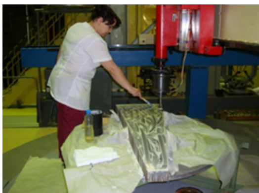
Рисунок 6. Финишная доводка матрицы
