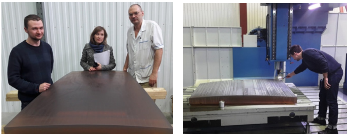
Рисунок 2. Программно-управляемое фрезерование внеосевой выпуклой асферической поверхности матрицы
