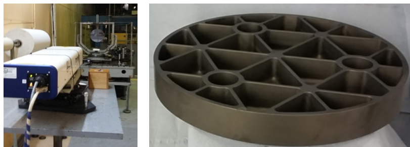
Рисунок 3. Зеркало Ø300 мм и стенд контроля при разгрузке в ленте
