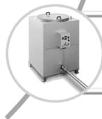
Специальные печи для расплавления полировальной смолы
