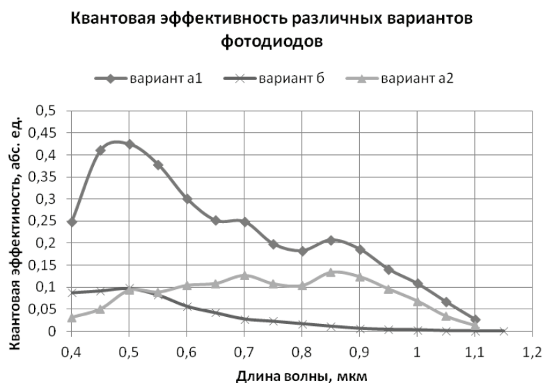
Рисунок 3. Спектральная зависимость квантовой эффективности фотодиодов различной топологии
